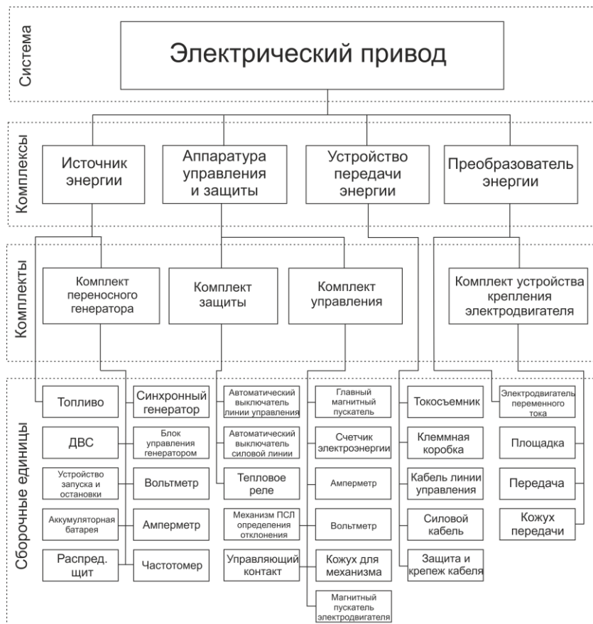
Рисунок П1.6 – Структурная модель электропривода с питанием от переносного генератора
