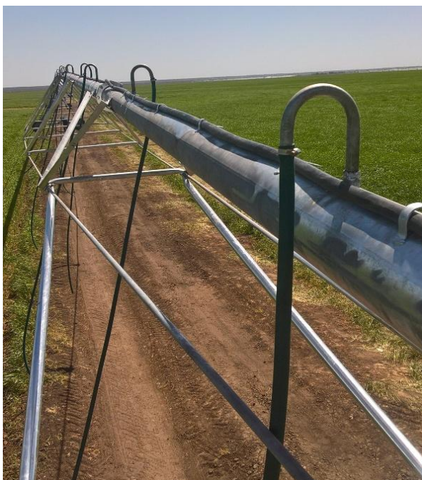
Рисунок 6.10 – Фрагмент производственных испытаний изменения диаметра с 219 на 159 мм водораспределительного трубопровода крайней секции
