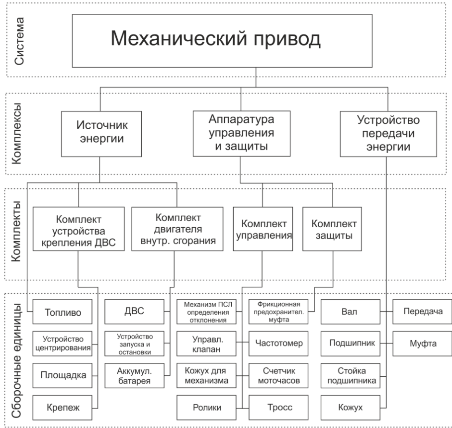
Рисунок П1.3 – Структурная модель механического привода
