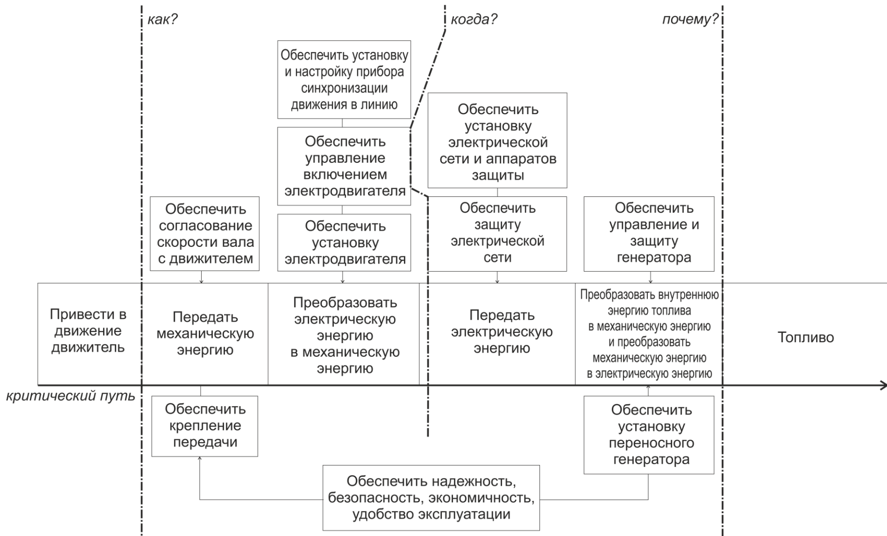
Рисунок П2.11 - Диаграмма функций системы электрического привода с питанием от переносного генератора по методике FAST
