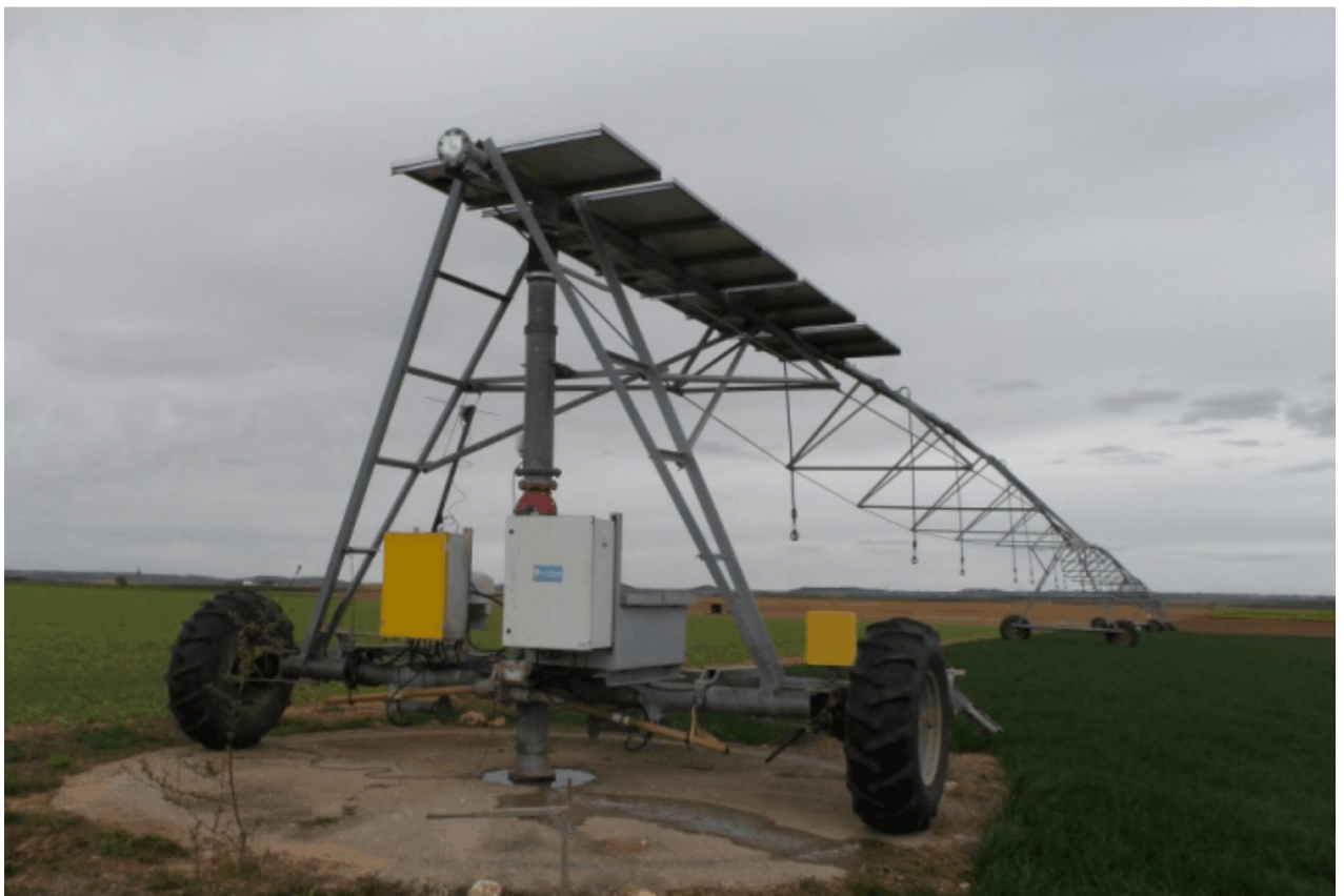
Рисунок 6.8 – Дождевальная машина с аккумуляторным питанием и солнечными батареями (Агреф, г. Комарно, Словакия)
