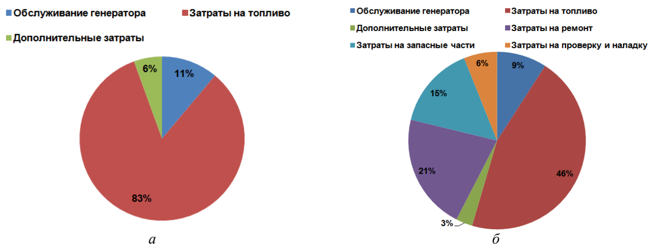
Рисунок 1.13 – Структура эксплуатационных затрат для МДЭК «Каскад» с переносным дизель-генератором: а – в первый год эксплуатации; б – на пятый год эксплуатации
