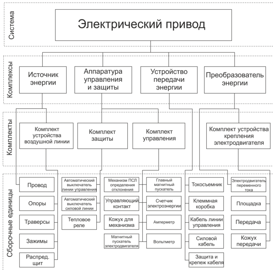
Рисунок П1.5 – Структурная модель электропривода с питанием от воздушной линии
