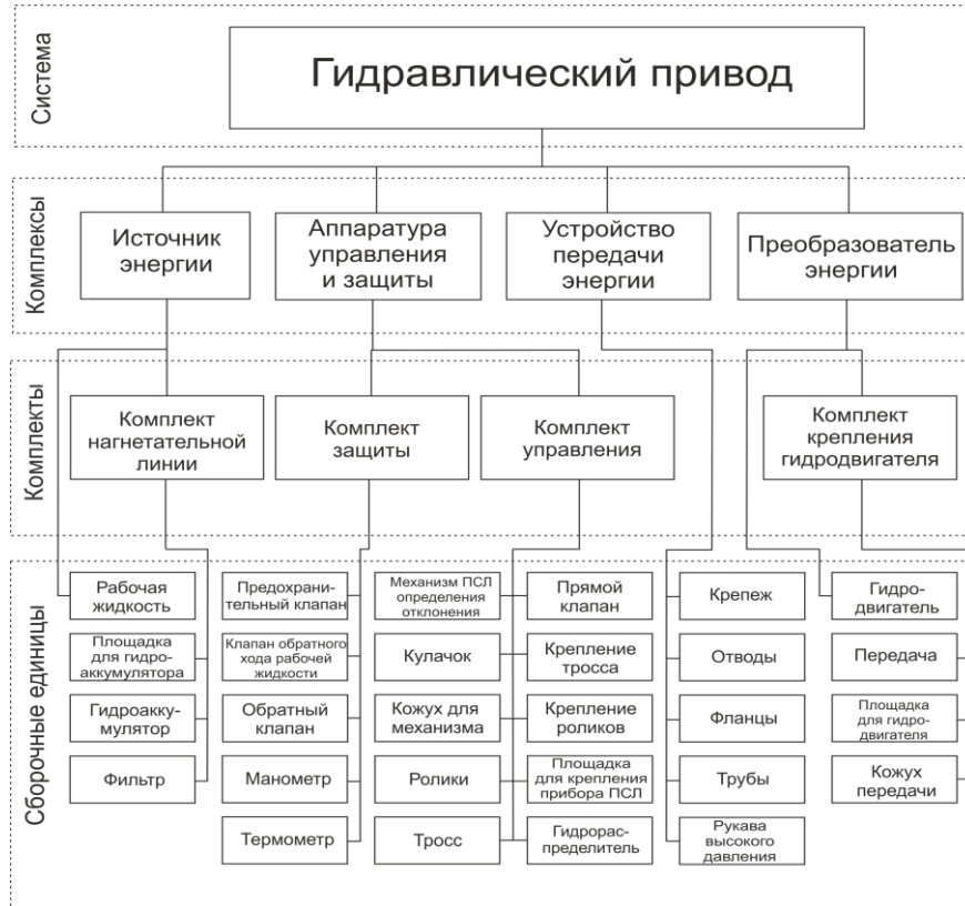
Рисунок П1.1 – Структурная модель гидравлического привода с гидродвигателем вращательного действия
