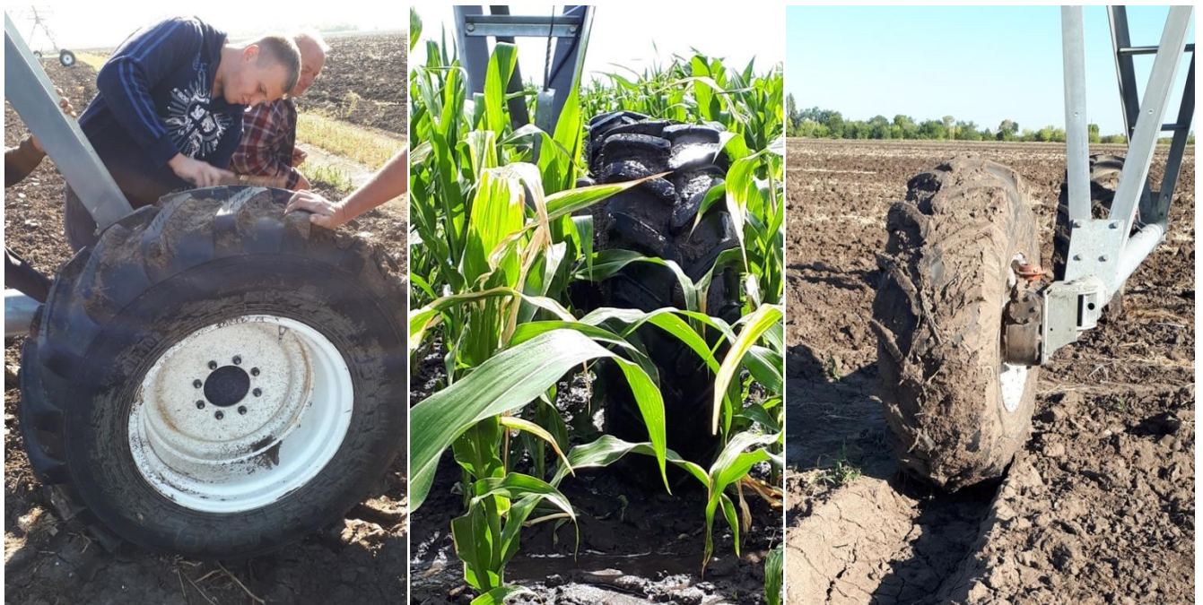
Рисунок 6.13 – Фрагмент производственных испытаний по изменению колес опорной тележки
