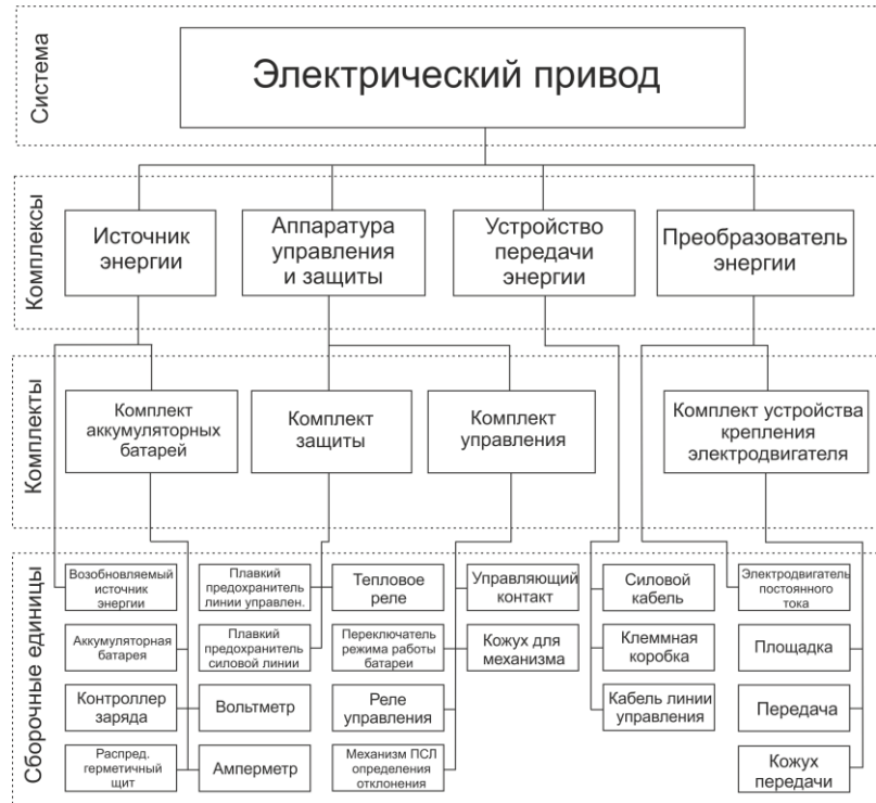
Рисунок П1.7 – Структурная модель электропривода с питанием от аккумуляторных батарей
