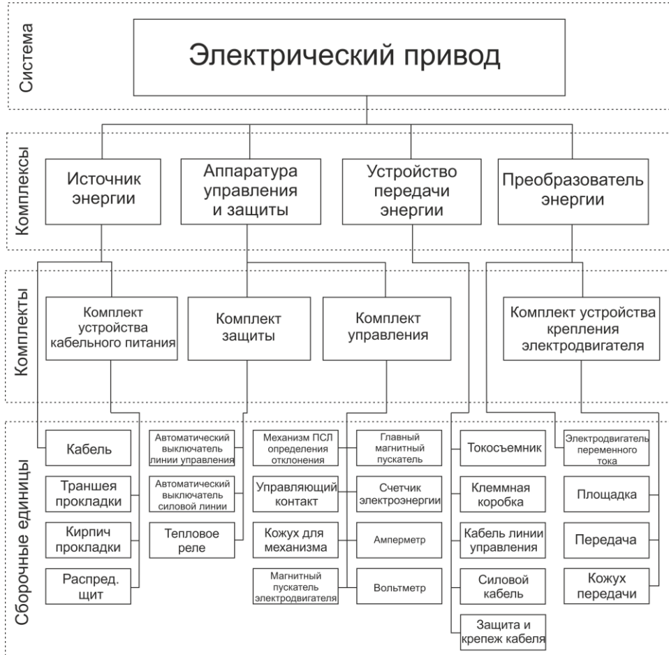
Рисунок П1.4 – Структурная модель электрического привода с кабельным способом питания
