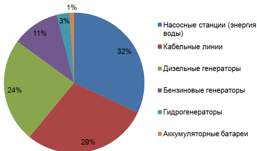
Рисунок 1.14 – Применение различных источников энергии опорных тележек ДМ
