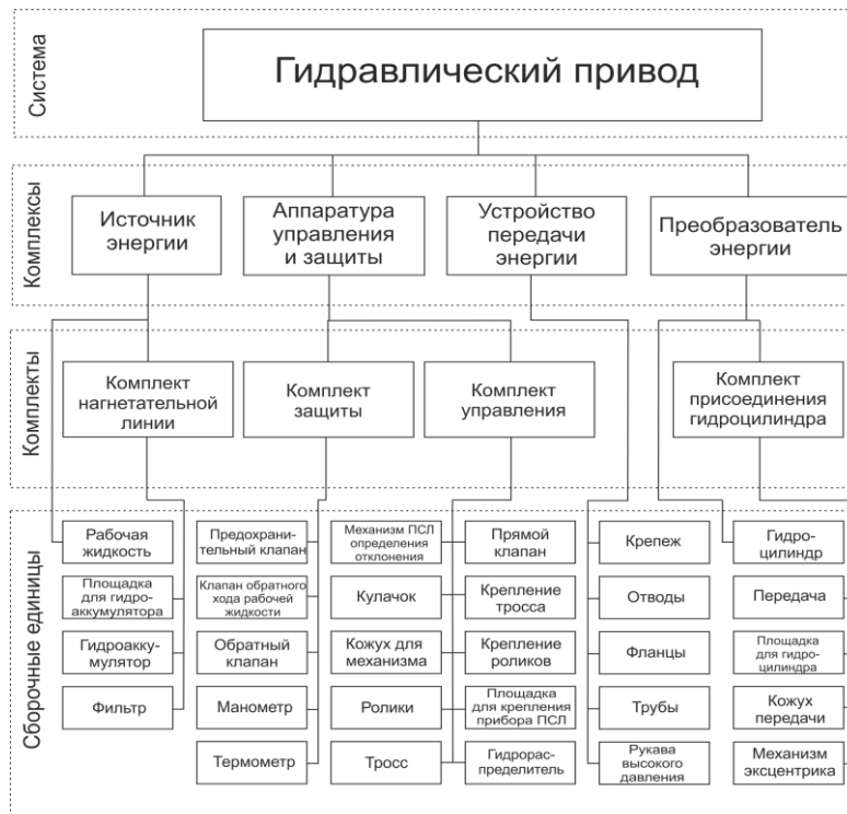
Рисунок П1.2 – Структурная модель гидравлического привода с гидродвигателем возвратно-поступательного действия
