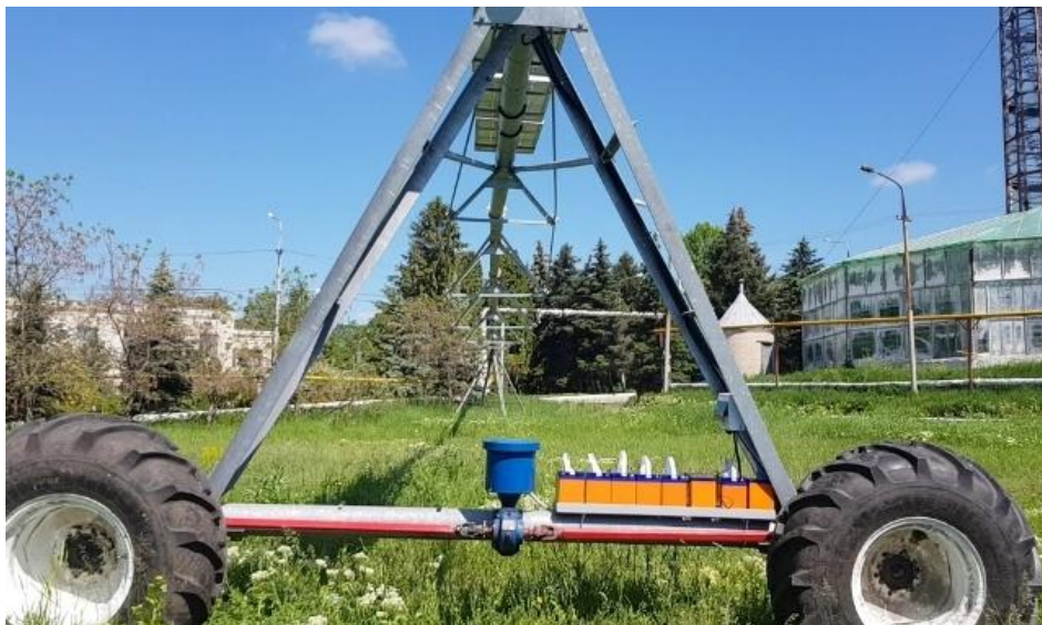
Рисунок 6.9 – Дождевальная машина с аккумуляторным питанием и солнечными батареями (УНПК «Агроцентр» СГАУ, г. Саратов)
