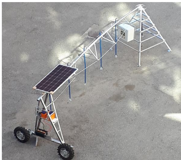
Рисунок 6.6 – Стенд секции дождевальной машины с аккумуляторным питанием и солнечными батареями (СГАУ, г. Саратов)
