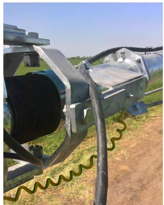
Рисунок 6.10 – Фрагмент производственных испытаний изменения диаметра с 219 на 159 мм водораспределительного трубопровода крайней секции
