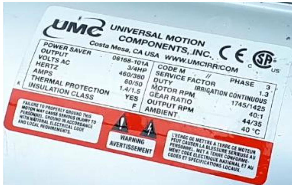
Рисунок 6.12 – Паспортные данные электродвигателя с редуктором, используемые на испытуемой дождевальной машине
