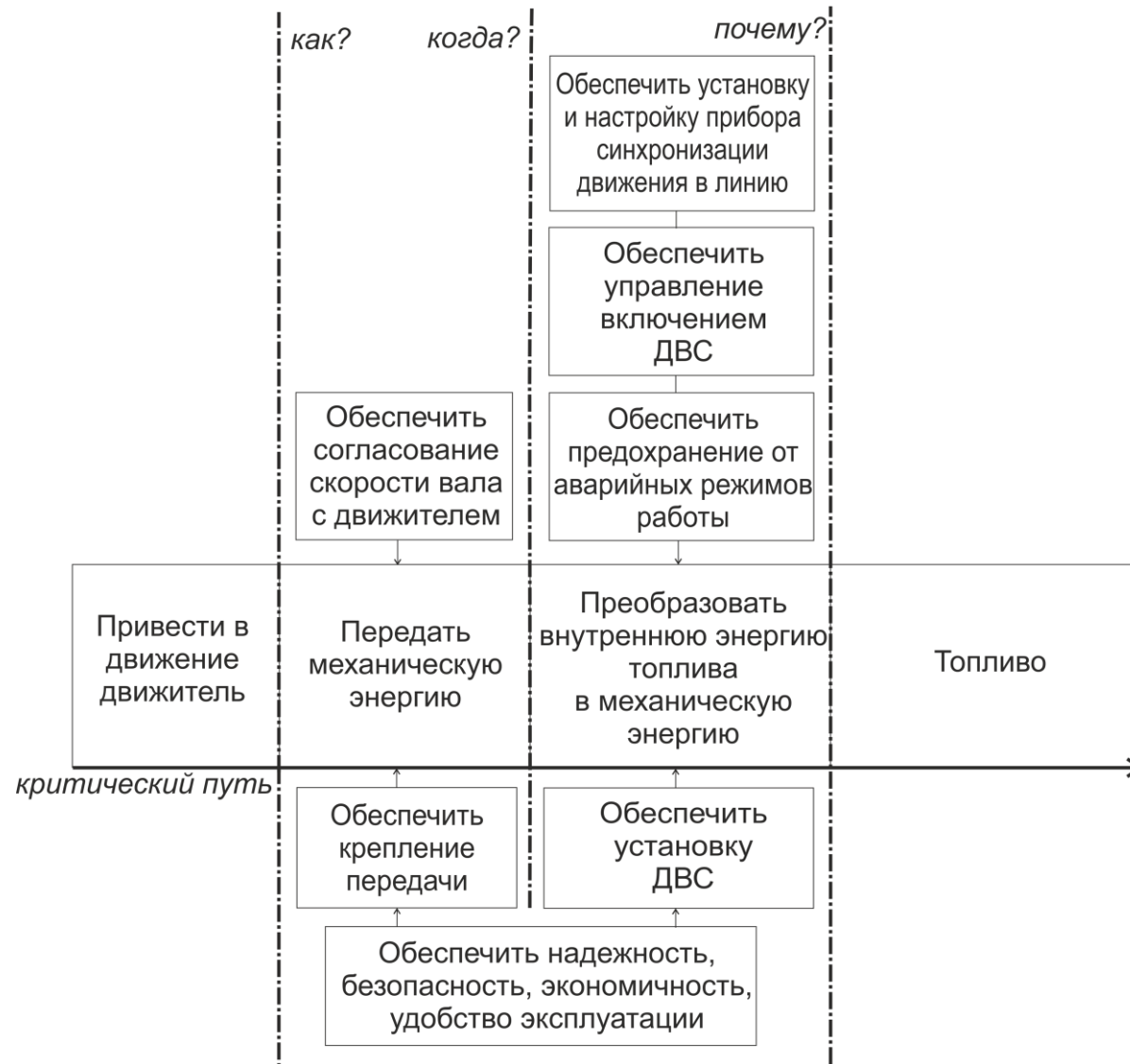
Рисунок П1.9 – Диаграмма функций системы механического привода по методике FAST
